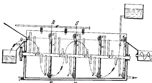
Zuckermasse, welche mittels schneckenförmig ange ordneter Quirle durch den in mehrere Abteilungen geteilten Apparat fortlaufend hindurchgeführt wird, entgegenströmt, gekennzeichnet durch die gemein-
